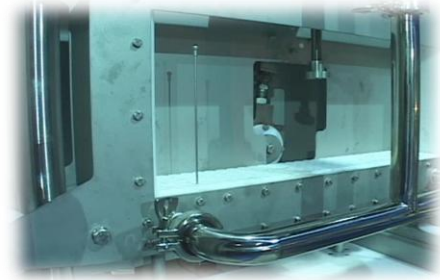
원 터치 핸들조작 으로 한 번에 니들 블록분해가능 One-touch handle operation allows needle block disintegration in one go
